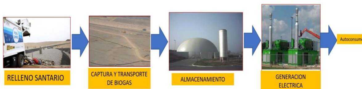
Fig. N° 04. Flujo de la Generación Eléctrica con Biogás
